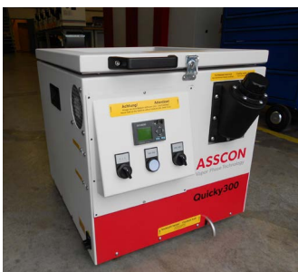
Figuur 13. Een batch-reflowmachine.
